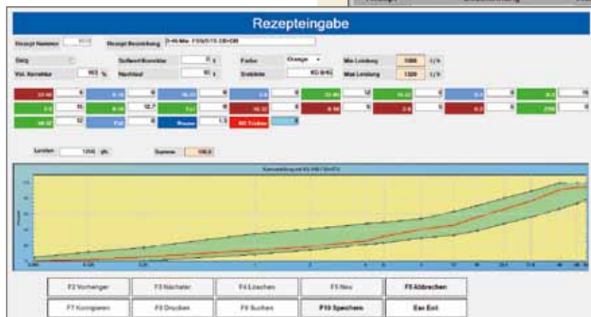
Masque des recettes avec fuseau granulométrique - Limite inférieure et supérieure
