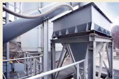
Basculé sous trémie avec vis sans fin, ingrédient dosé gravimétriquement
